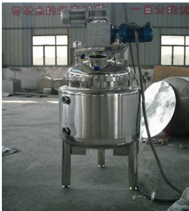
Fig. 1.1 Cisternă utilizată în producție pentru omogenizarea ingredientelor utilizate la obținerea rachiurilor și a lichiorurilor.
