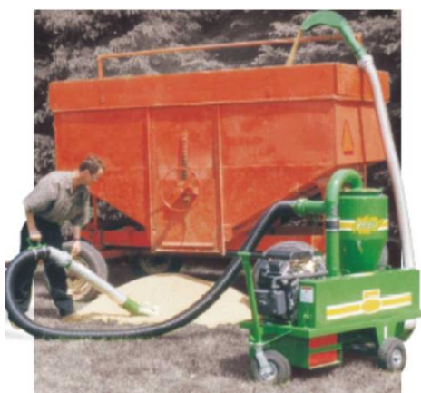
Fig. 2.43. Instalație mobilă pentru descărcare și transport pneumatic
