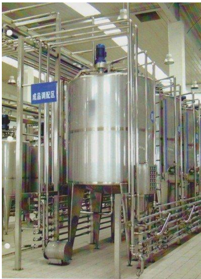
Fig.3.13 Cisternă de capacitate ridicată utilizată la omogenizarea amestecului format din fructe sau plante și alcool etilic diluat.
