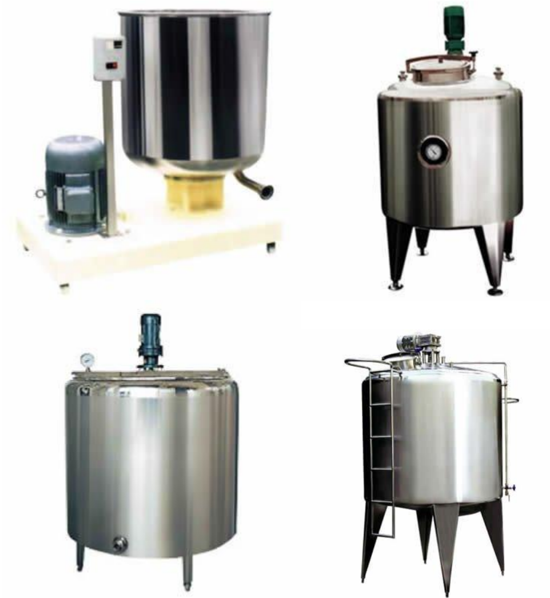
Fig. Cisterne din oțel inoxidabil, prevăzute cu diferite tipuri de agitatoare, utilizate la omogenizarea amestecurilor pentru rachii și lichioruri.
