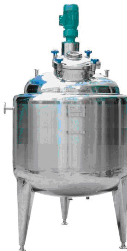
Fig.3.13 Cisternă de capacitate ridicată utilizată la omogenizarea amestecului format din fructe sau plante și alcool etilic diluat.
